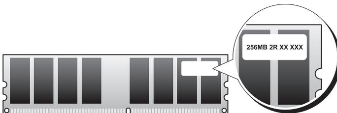
**HINWEIS:** Installieren Sie DDR2-Speichermodule immer in der Reihenfolge, die auf der Systemplatine angezeigt ist.
